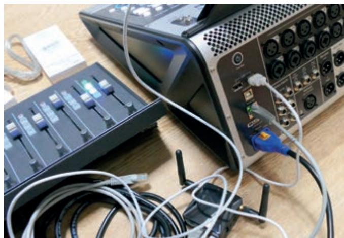
Controller und iPad lassen sich mit oder ohne Kabel mit dem QSC TouchMix verbinden, was dem Anwender gleich eine Reihe verschiedener Optionen bereitstellt
